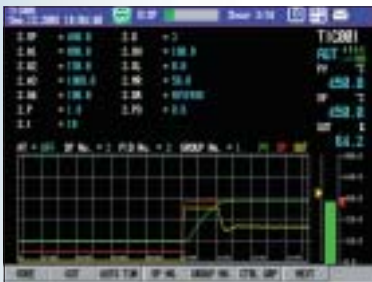
Настроочный дисплей С этого дисплея можно задавать различные параметры контура управления. Можно отобразить и задать до 21 параметра.
