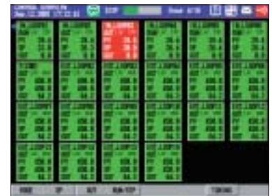
Сводный дисплей управления Этот дисплей обеспечивает обзор контуров управления. Можно использовать для контроля состояний сигнализации всех групп.
