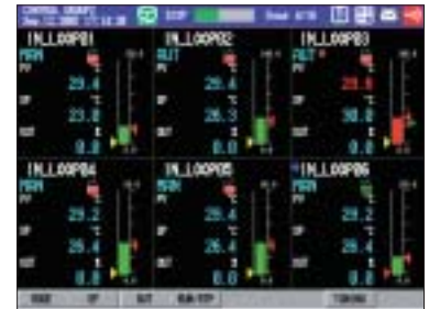
Дисплей гибридного типа Этот дисплей - для контроля контуров управления (комбинация графического и цифрового отображения).
